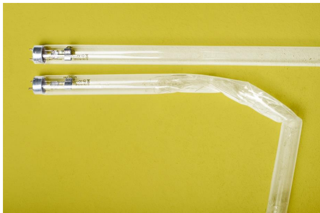
4. ábra: A védőfólia a lámpa törése esetén a szilánkokat felfogja
