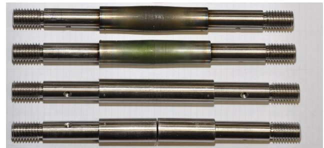
4. ábra: Gleeble mintadarabok a kísérletek után, fentről lefelé: referenciaminta (RG3), hegesztési minta (DG3) azonos terheléssel, alatta a nyers kiindulási minták
