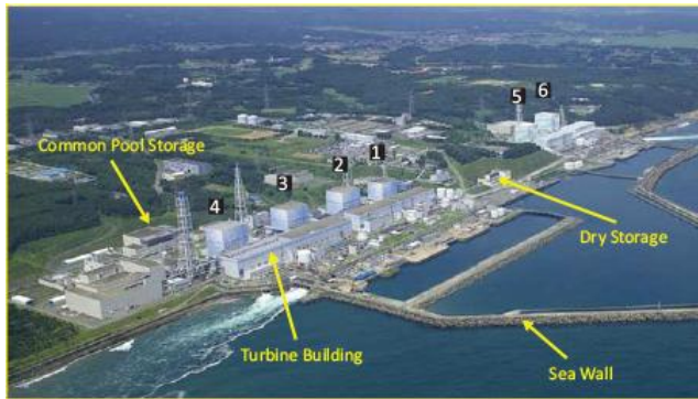
6. ábra: Légi felvétel a Fukushima Daiichi Atomerőműről a 2011. március 11-i Nagy Kelet-Japán Földrengés és Szökőár előtt. A reaktorblokkok helyét számok jelzik (azaz 1-6. blokkok). A turbinaépületek, a partfal és a közös kiégett fűtőelem-tároló (medence és száraz) elhelyezkedése is feltüntetésre kerül. [8]
