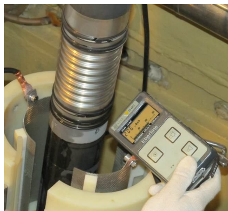
7. ábra: Dózismérés a labirint hornyok dekontaminálása közben
