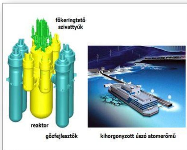
3. ábra: Orosz úszó atomerőmű: a primer kör és a partnál telepített állapot [10]
